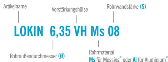
\*Bei Kupferrohr Verstärkungshülsen aus Messing (Ms) und bei Aluminiumrohr Verstärkungshülsen aus Aluminium (Al) verwenden.
